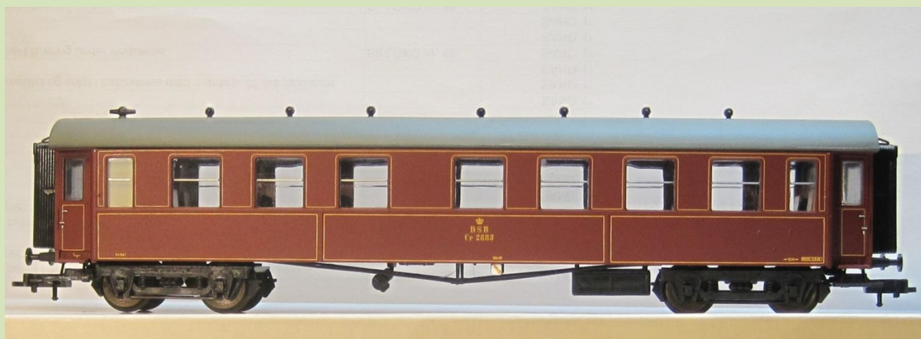
Heljans model af CP 2883 fra 2008. Taget gaber lidt, en skavank mange CP vogne lider af. Problemet lader sig rimeligt let afhjælpe ved at fjerne støbegreter og afpudsning af interiør og vinduer.
