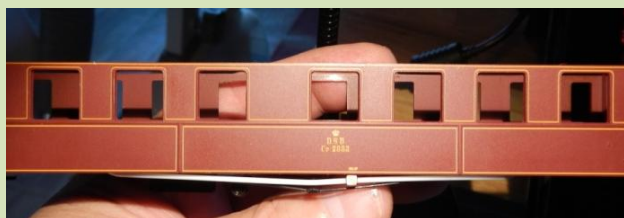
Her er dampprøret monteret på vognen, når det bliver malet i en mørk ubestemmelig sortagtig farve, vil det ikke gøre meget væsen af sig selv.
