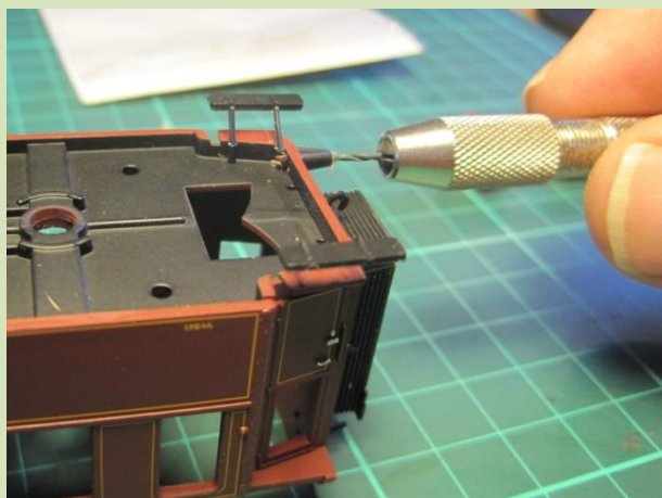
Der bores igennem med et 1 mm. bor, det går lige nøjagtig bag om benet til trinnet, inden man borer op til 2 mm. hul, skal de nederste trin fjernes.
