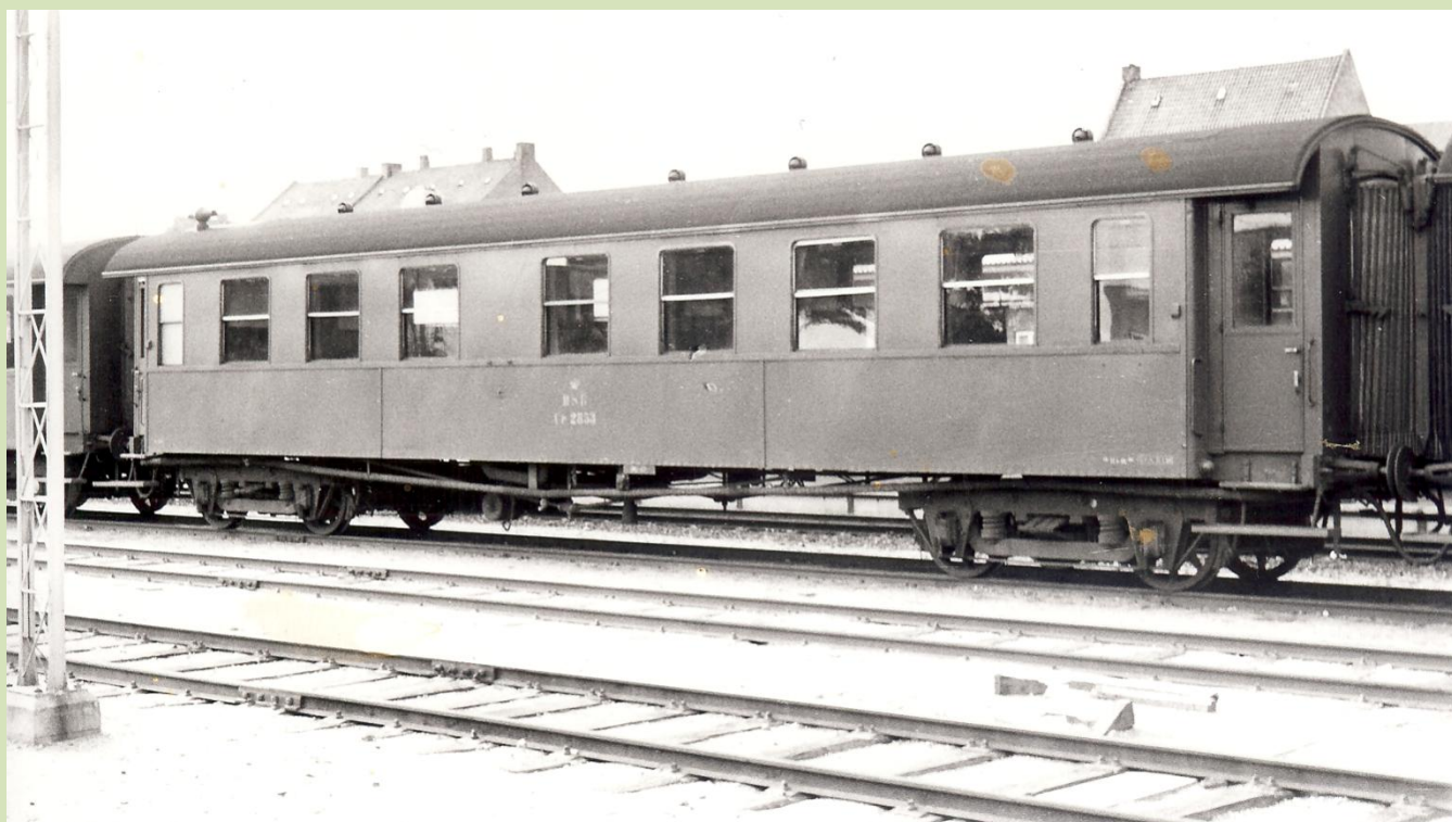
Cp 2853. På denne vogn kan man se dampvarmerørets placering i hele vognens længde, det er langt fra altid, man kan det. I model er det ikke uden plads problemer at føre røret så synligt forbi bogierne. På det laveste punkt på røret er der monteret en vandudskiller, så røret ikke frostsprængte om vinteren, når vognen var uden varmemforsyning tilsluttet, en ganske nødvendig detalje.
